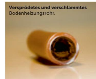
Versprödetes und verschlammtes Bodenheizungsrohr.
